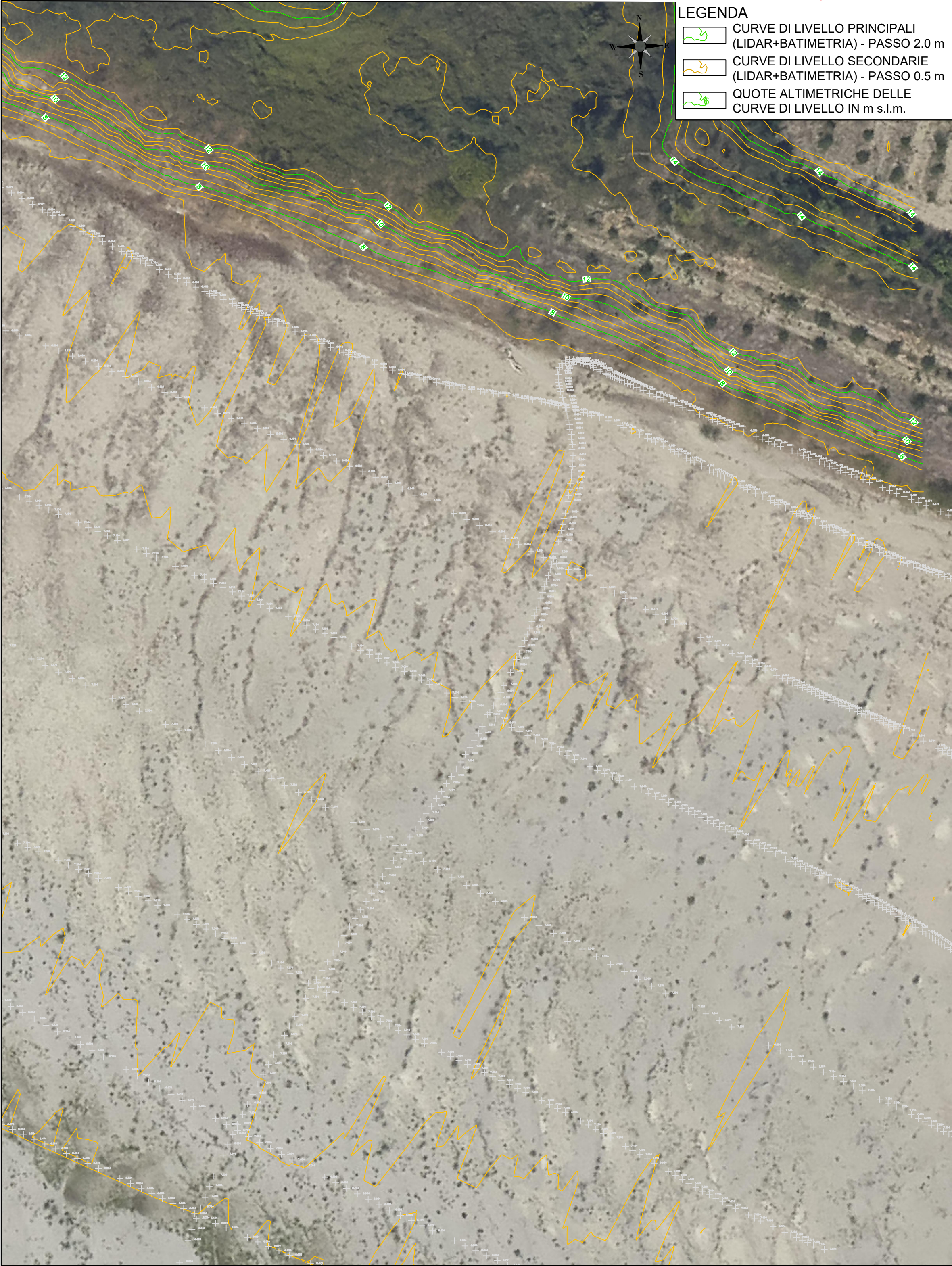
MODELLO DEL TERRENO (INTERPOLAZIONE DEL RILIEVO LIDAR2022 E DEL RILIEVO BATIMETRICO) - SCALA 1:500
